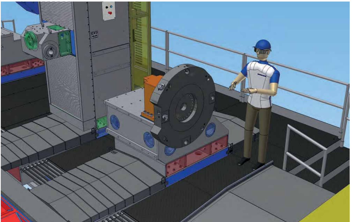
PARTICOLARE TORNITURA CON TORRETTA A DISCO TURNING DETAIL WITH DISK TURRET
